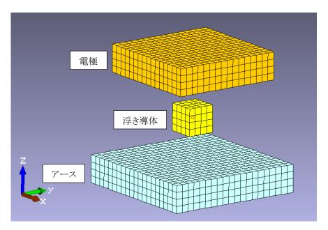
[解析データ]-[荷重条件]-[等ポテンシャル]を選択し、「浮き導体」に対して設定を行います。 (例では、物性「浮き導体」のみの表示とし、加えて「ZX 面」表示としています)
