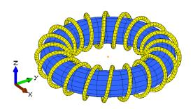
トーラス状の鉄心に螺旋状のコイルを巻きつけた対象物を磁場解析します。 「PHOTO-EDDYTM」は、空気メッシュを作る必要がありませんので、複雑な形状をした対象物を 簡単に取り扱うことができます。
