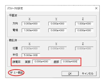
この設定で[解析]-[実行]を行いますと、PHOTO-Series 画面の下のメッセージ欄に「散乱断面積」の値が出力されます。
