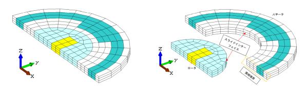
ステータに対向して回転移動するロータ(永久磁石)を、スライドインターフェース機能を使用して 磁場解析します。
