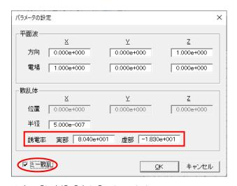
この設定で[解析]-[実行]を行いますと、PHOTO-Series 画面の下のメッセージ欄に「散乱断面積」、「吸収断面積」と「全断面積」の値が出力されます。
